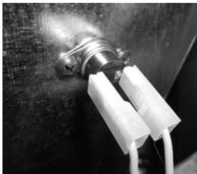
Termostato depósito de água
