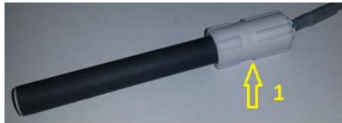
Resistência Cerâmica Caldeira automática de pellets.
