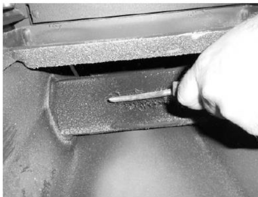
Limpeza da chapa defletora
