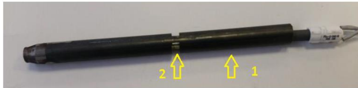
Tubo de suporte resistência cerâmica da caldeira automática.
