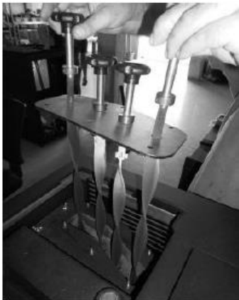
Limpeza do circuito de fumos e extrator
