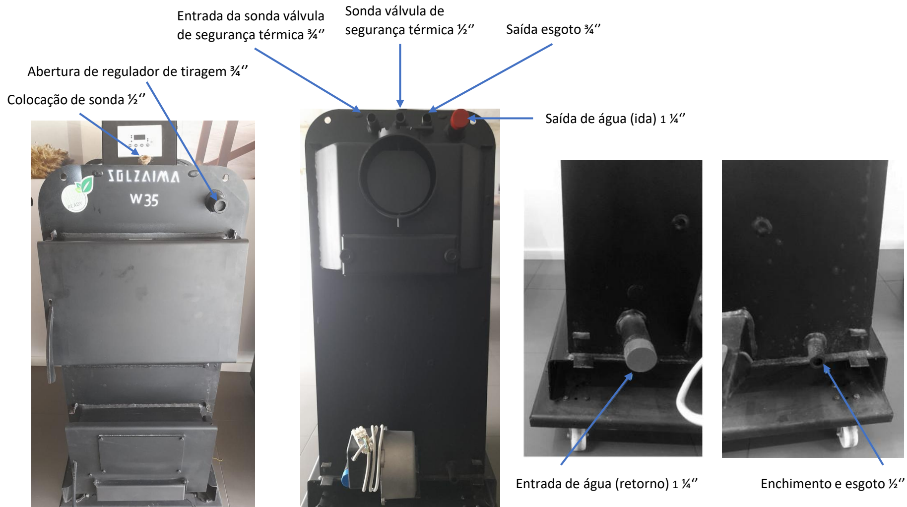
Fig. - Ligações hidráulicas caldeiras SZM W PLUS
